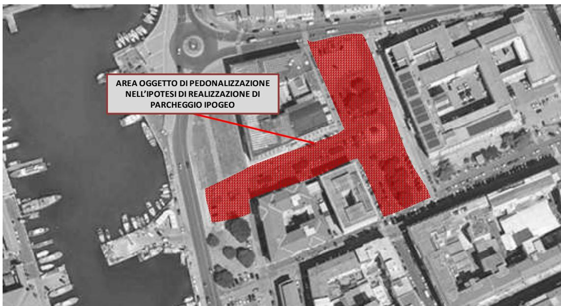
L'ipotesi progettuale consiste nella realizzazione di un parcheggio di tipo ipogeo in sostituzione (con aumento del numero di posti auto) della sosta di superficie a pagamento compresa tra Piazza Unità d'Italia e Piazza Tacca.
